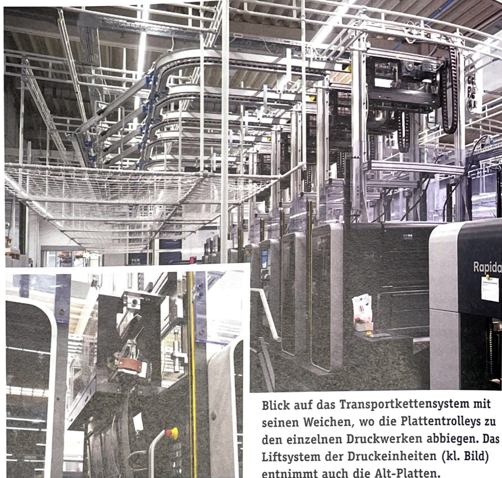
Zwei Ausgänge für den Plate Manager: Oben zur Transportkette für die Rapida-Platten und unten eine klassische Rollenbahn für die Speedmaster-Platten, die auf Plattenwagen abgelegt werden.
