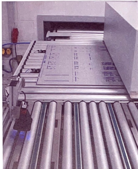
Auf dem Weg zum Plattenspeicher (rechtes Bild) erfolgt die Datamatrixcode-Abtastung und Beschriftung der Druckplatten.
