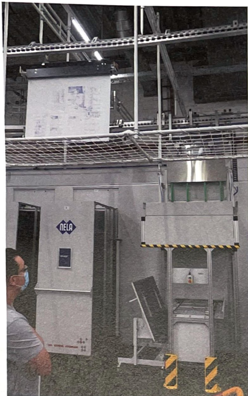
Zwei Ausgänge für den Plate Manager: Oben zur Transportkette für die Rapida-Platten und unten eine klassische Rollenbahn für die Speedmaster-Platten, die auf Plattenwagen abgelegt werden.
